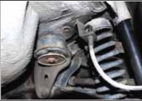
Bild oben: Machen beim Anfahren deutlich "klong": Die Lager des Achsträgers.
