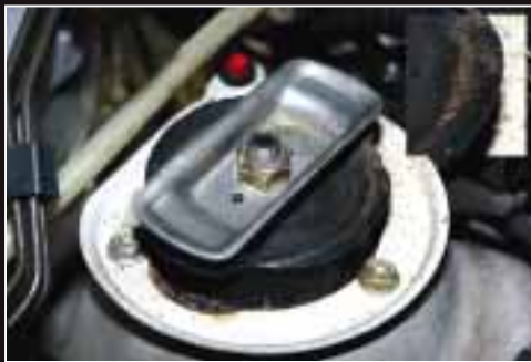
Bild re. oben: Untere Querlenkerlager vorne kann man wechseln, gerissene Konsole nicht. Bild rechts: Domlager. Gelegentlich eingegrissen, aber leicht und preiswert zu wechseln.
