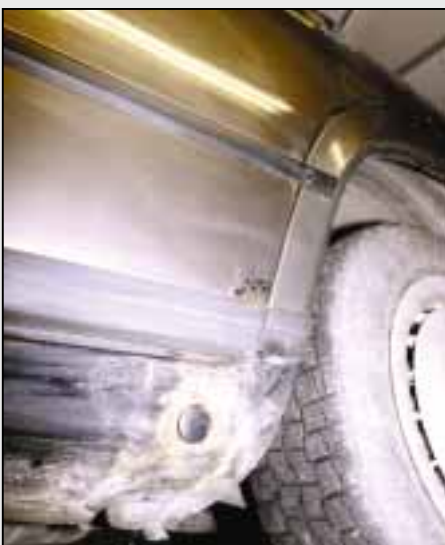
Bild links und oben: Nicht schön, nicht original, nicht selten anzutreffen: Durchgerostete oder schon geflickte Wagenheberaufnahmen
